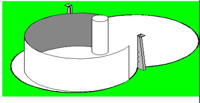
**Важное указание:** Чтобы стальная стенка временно держалась, уложите профили поручней на верхний край стальной стенки.
